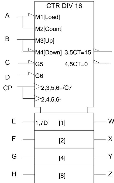
a) Sabendo que  $(W, X, Y, Z) = (0, 1, 0, 0)$ , que valores lógicos e/ou transições têm que ser aplicados nas entradas do integrado para que após um único ciclo de relógio W, X, Y e Z passem para:
